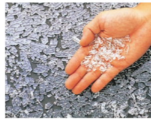
強化ガラスが割れた場合(参考写真)
