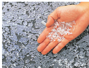
強化ガラスが割れた場合(参考写真)
