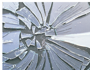
一般の板ガラスが割れた場合(参考写真)
